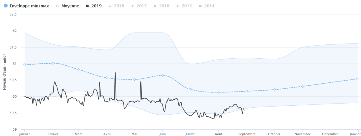
Figure 2 : Mesure du niveau statique dans un ouvrage de production et comparaison à son historique
